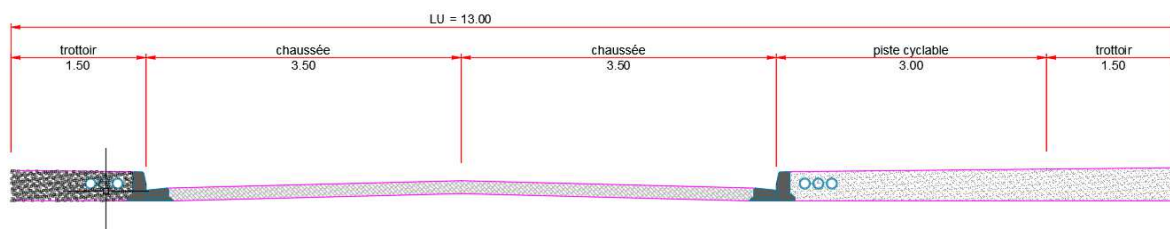
Illustration 25. Profil de chaussée type de la rue du pavillon
